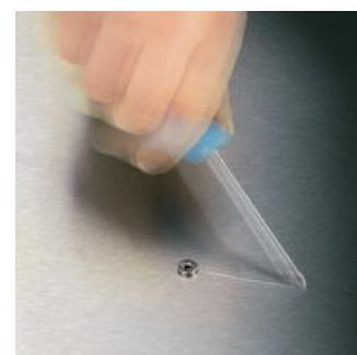
Часто при завинчивании отвертка выскользывает из винта. Иногда при этом повреждается ценная поверхность или дело даже кончается травмой. В отвертках Wera наконечник Lasertip обработан лазером до микроскопической шероховатости. Такая шероховатая поверхность буквально "врезается" в головку винта. О случайному соскальзыванию отвертки можно забыть.
