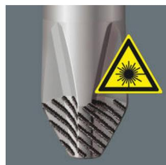
Узко сфокусированный луч лазера создает структуру поверхности с острыми кромками. Наконечник Wera Lasertip крепко "цепляется" за шлиц винта и предотвращает выскользывание из него. Идеален для прямого шлица, Phillips и Pozidriv.
