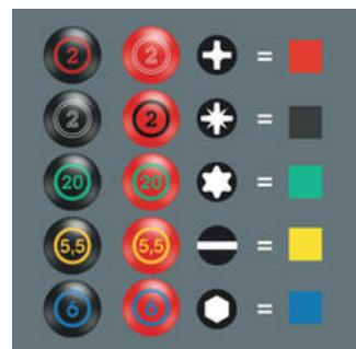
Отвертки, снабженны индикатором "Take it easy": цветовая кодировка профиля наконечника и маркировка размера на ручке отвертки.
